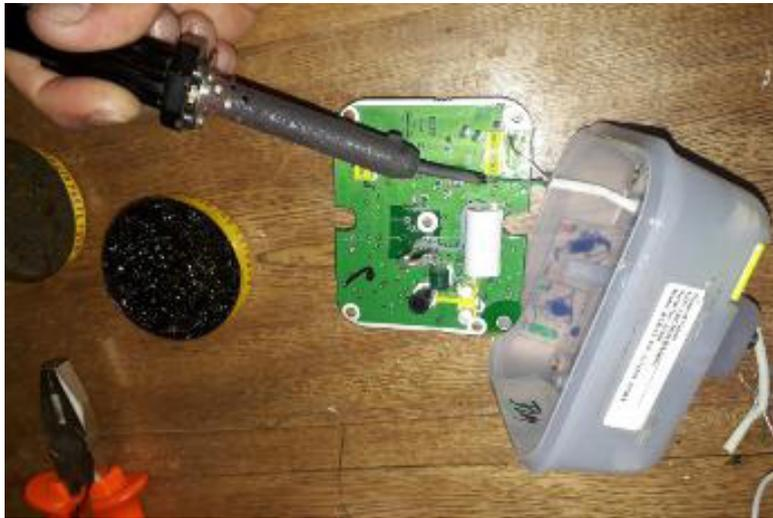
*Figura 1. Modificación circuito electrónico – Reed switch - Fuente: Autores*
