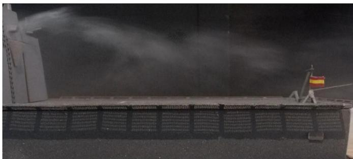
Figura 7. Visualización del flujo mediante humo (Fuente: UPM)
