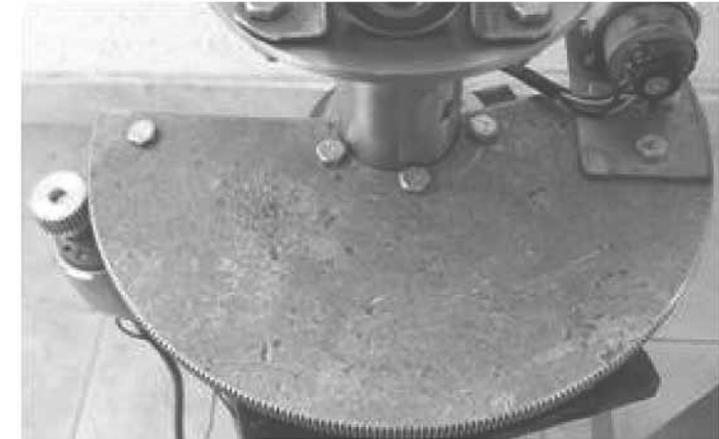
Figura 7. Rotación en ángulo de azimut
