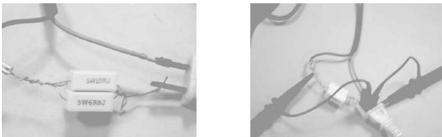
**Figura 8.** *Conexión de resistencias conectadas en paralelo y conexión de pinzas del osciloscopio*
