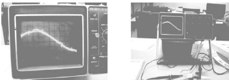
**Figura 13. Gráficas de osciloscopio de señal de tensión y corriente con corrección de FP**
