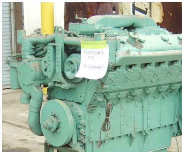
Figura 1. - Motor MTU serie 71 de 450 bhp @ 1800 rpm
