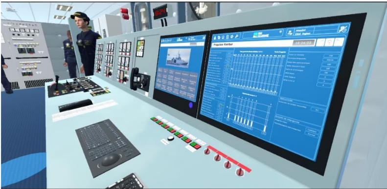
Desarrollar un prototipo de consola de ingeniería en realidad virtual y simulación en el entrenamiento de tripulaciones en procedimientos de emergencia (planta de ingeniería) para unidades tipo de la flota naval de la armada nacional de Colombia.
