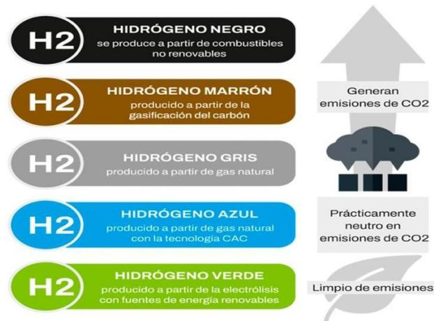
**Figura 10.** Tipos de hidrógeno. Fuente: UPM.
