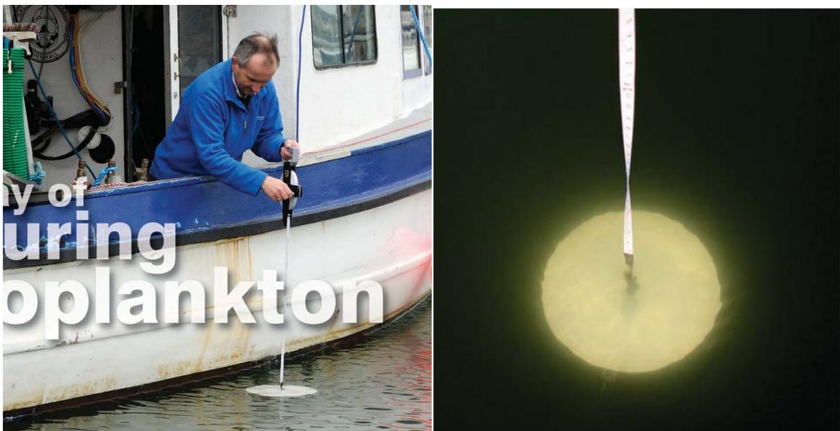
**Figura 2.** Medición de la transparencia del agua, mediante el Disco Secchi. Tomado de: <http://www1.plymouth.ac.uk/marine/secchidisk/Documents/TheMarineScientist.pdf>
