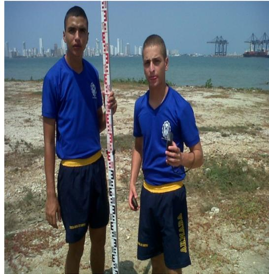
Figura 1. Levantamiento de perfiles de playa con nivel de precisión y miras.
