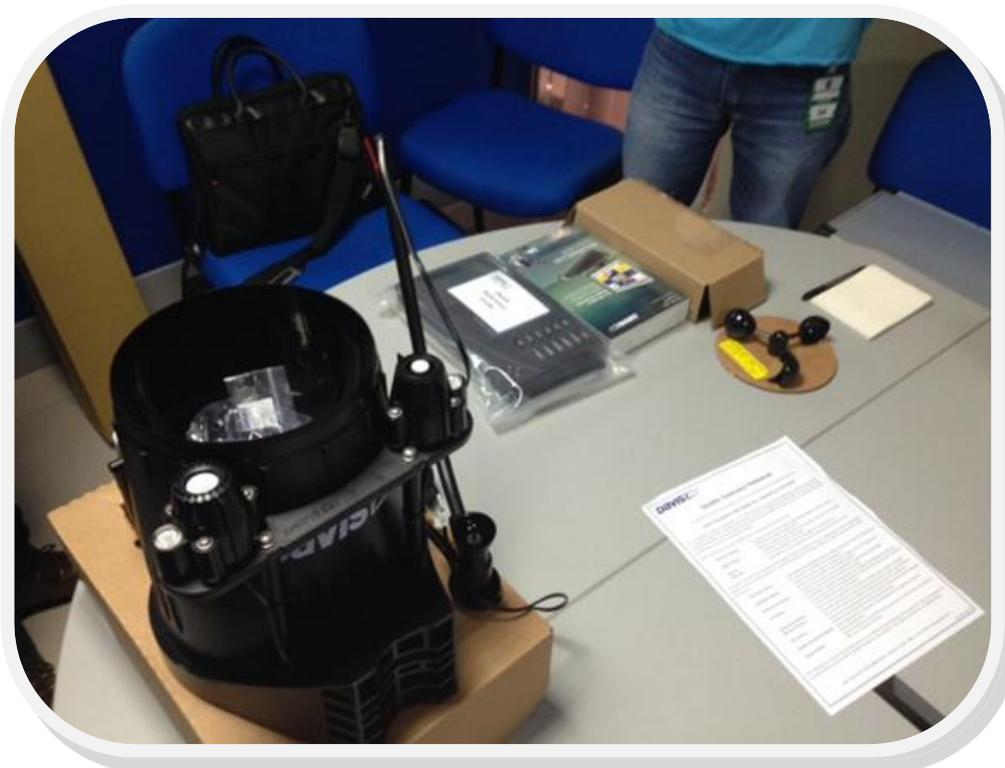
**Figura 1.** Estación Meteorológica Davis Advantage Pro Plus 2
