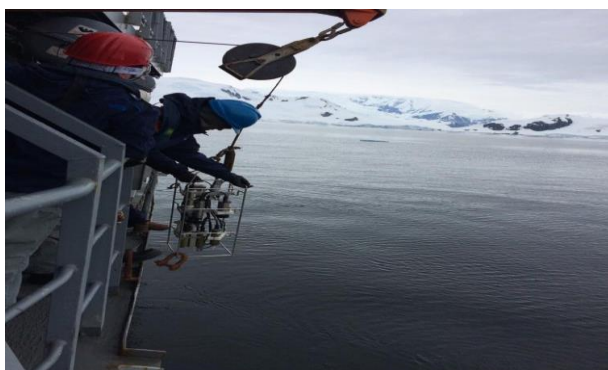
Figura 9: Toma de datos in situ con CTD
